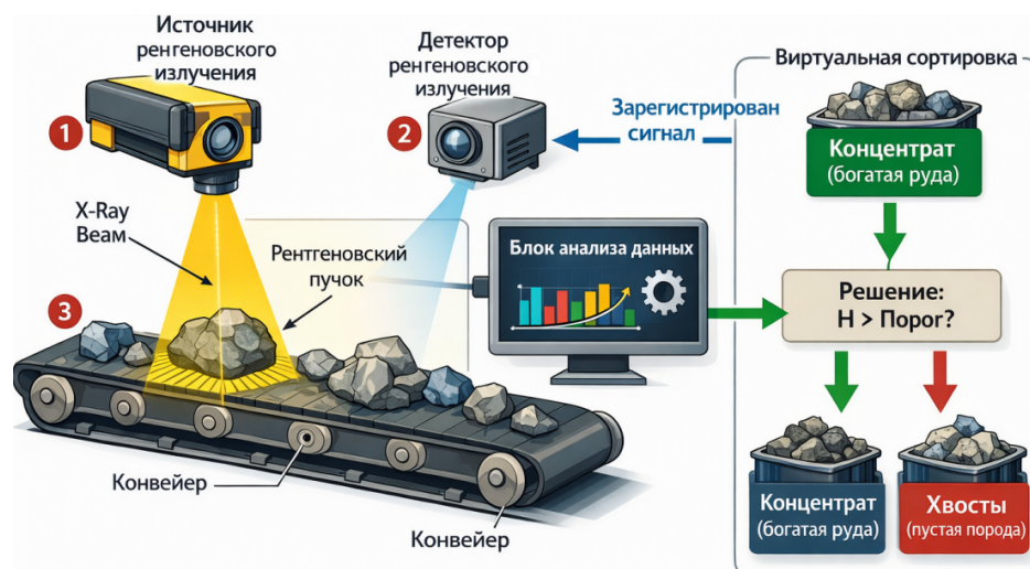
Рис.5 - Схема виртуальной сортировки кусковой руды
