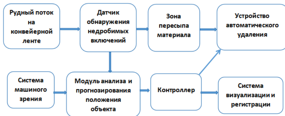
Рис.2 - Функциональная схема системы обнаружения и автоматического удаления недробимых включений на конвейерной линии
