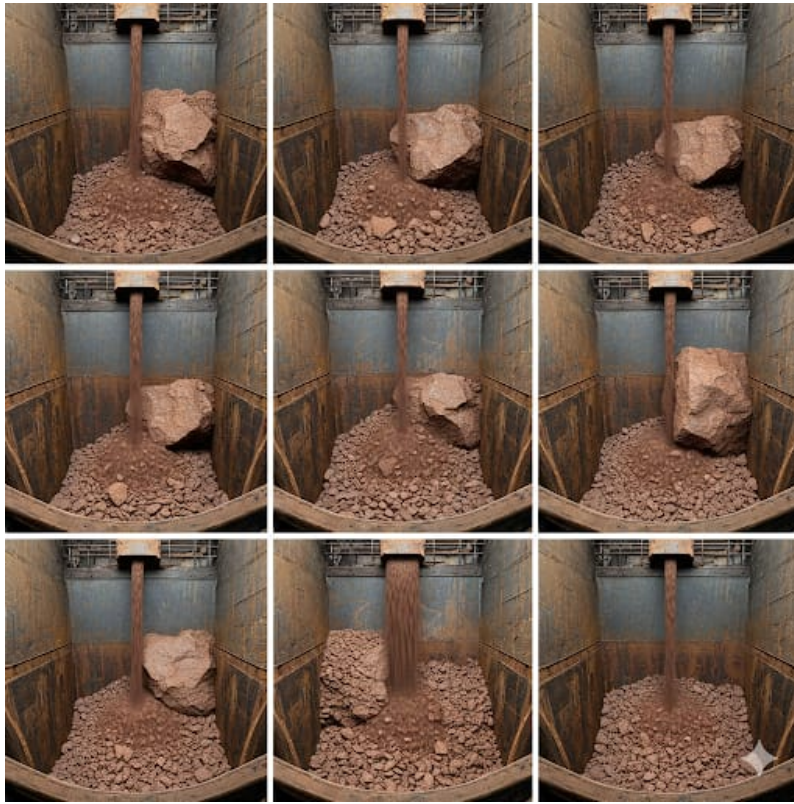
Рис.1 - Кадры съемки распределения руды внутри бункера
