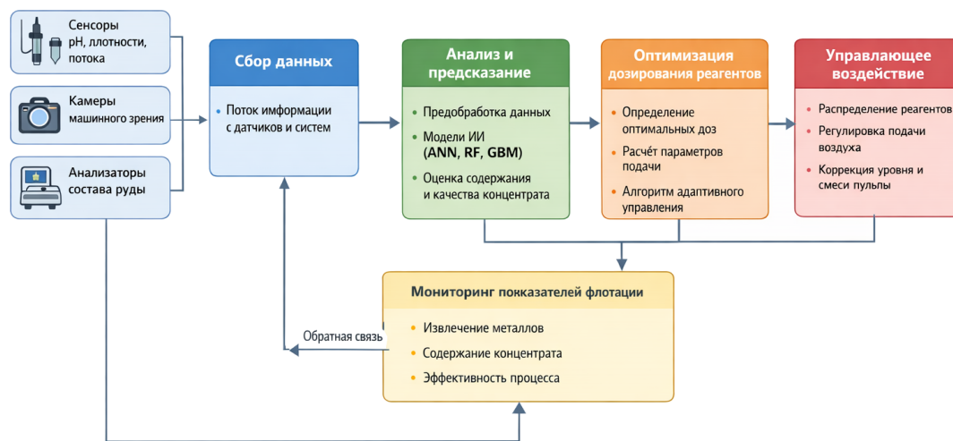
Рис.6 - Алгоритм автоматизированного управления процессом флотации
