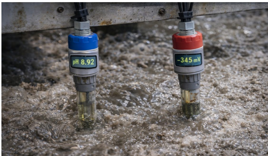
Рис.3 - Установка электрохимических датчиков в пульпу
