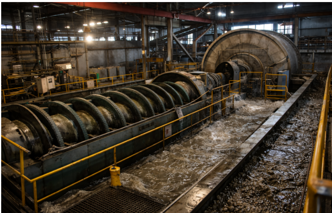
Рис.2 - Процесс измельчения рудной пульпы в шаровой мельнице
